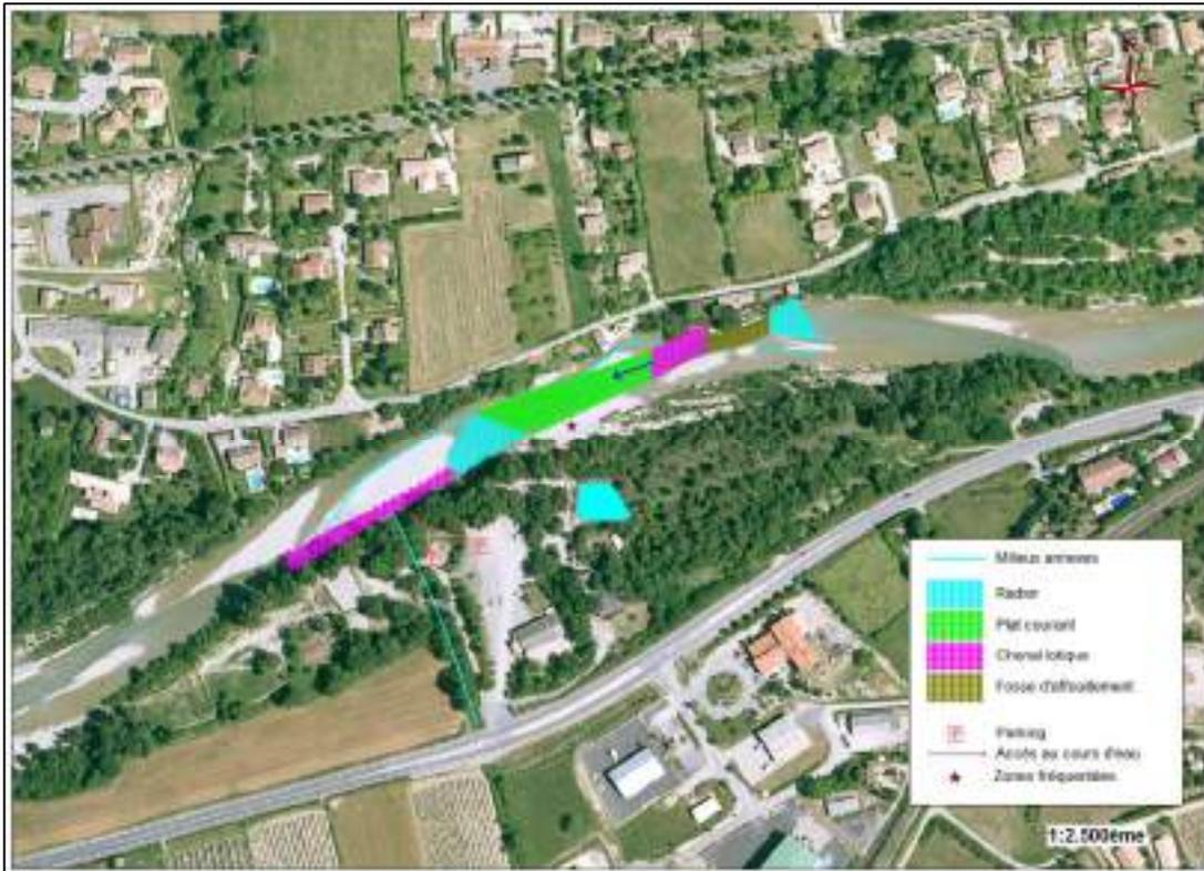
Figure 89 : Cartographie des faciès d'écoulement au abords du Pont de la D93
